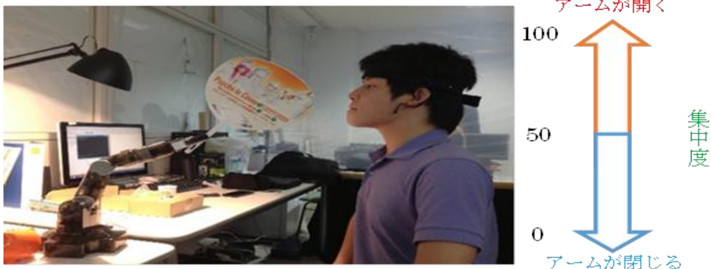
図1 集中度パラメータを利用したロボットアーム操作の様子
