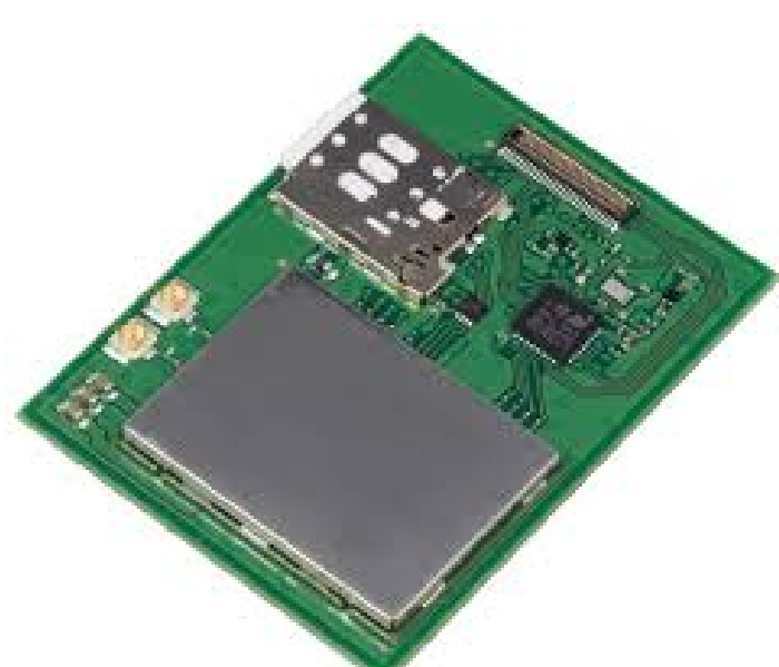
図3 無線通信モジュール
