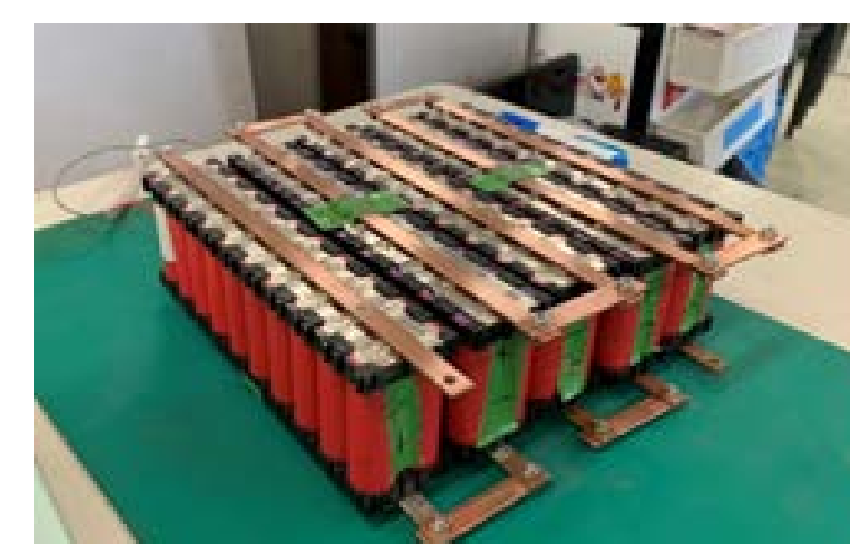
図6 組電池にしたバッテリー
